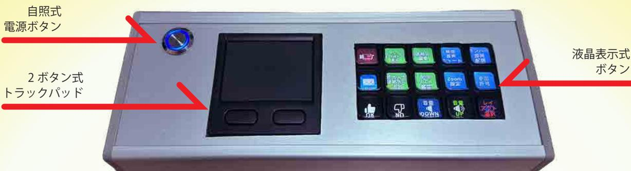
操作室や内視鏡室のテーブルはすでに複数のキーボードやマウスなどの機器で埋め尽くされています。新規の機器の追加は最小限であるに越したことはありません。そこで、AdviceView コンソールは自照式システム電源ボタン、2キー搭載のトラックパッド、15液晶ボタンを一体化、小型化しました。このコンソールでほとんど全ての操作を行います。
